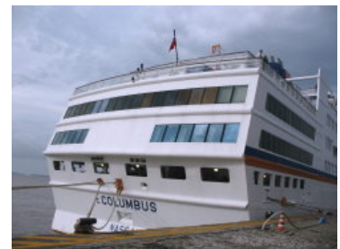
Heckansicht - Maschinenräume, Restaurant und Lounge vertikal übereinander
